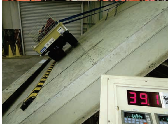
③コンテナ積載状態（偏荷重）の左右方向の静的転倒角（左下：左側転倒、右下：右側転倒）
