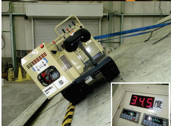
③コンテナ積載状態（偏荷重）の左右方向の静的転倒角（左下：左側転倒、右下：右側転倒）
