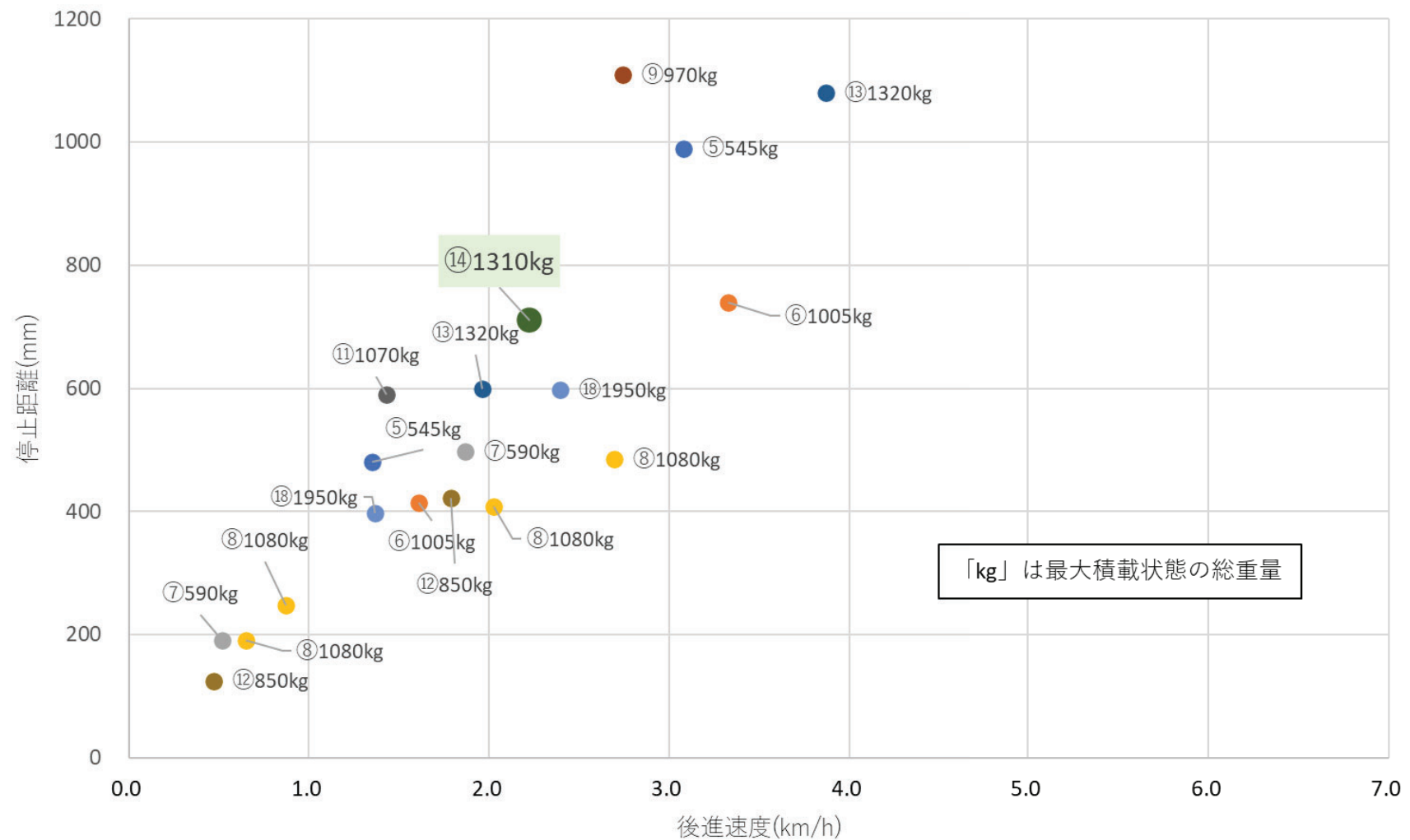
図2 最大積載状態における歩行後進速度および停止距離の比較 ※緊急停止ボタン操作時
