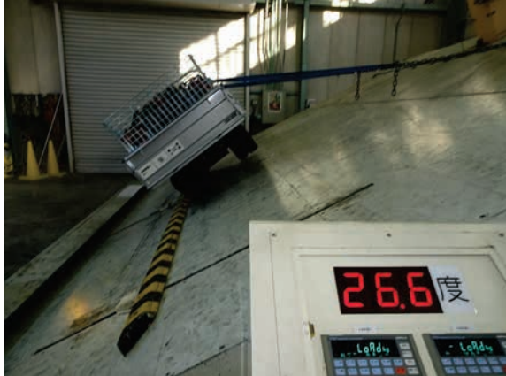
④ばら積みの最大積載状態(等荷重)での左右方向の静的転倒角(左下：左側転倒、右下：右側転倒)
