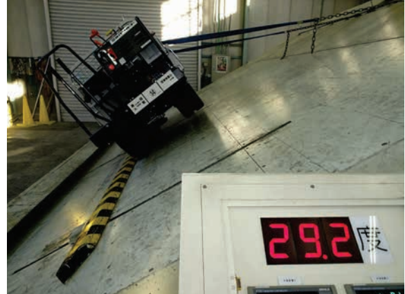
④ばら積みの最大積載状態(等荷重)での左右方向の静的転倒角(左下：左側転倒、右下：右側転倒)
