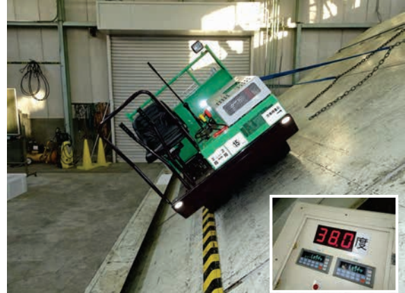
②コンテナ積載状態（等荷重）の左右方向の静的転倒角（左下：左側転倒、右下：右側転倒）
