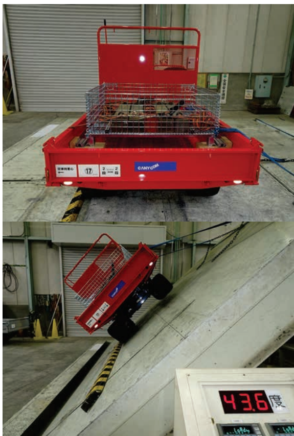
②コンテナ積載状態（等荷重）の左右方向の静的転倒角（左下：左側転倒、右下：右側転倒）
