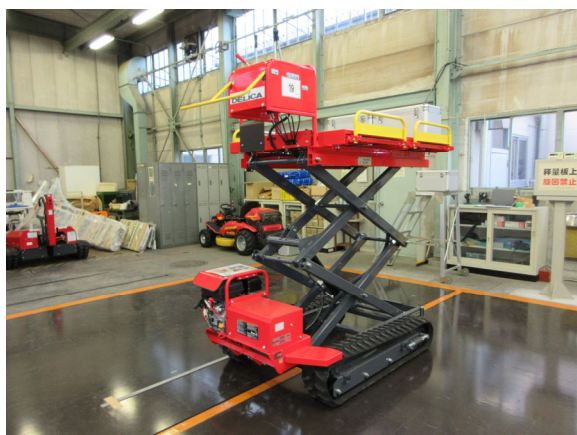
左写真：前方向不利時の左右分担荷重測定、右写真：前方向安定角測定
