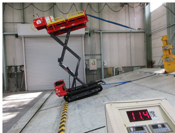
左写真：前方向安定角測定、右写真：後方向安定角測定
