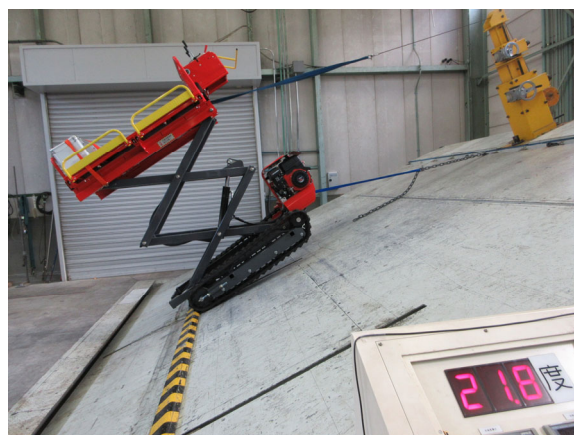
左写真：前方向不利時の左右分担荷重測定、右写真：前方向安定角測定
