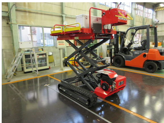
左写真：後方向不利時の左右分担荷重測定、右写真：後方向安定角測定
