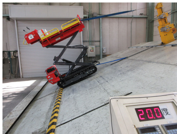
左写真：後方向不利時の左右分担荷重測定、右写真：後方向安定角測定
