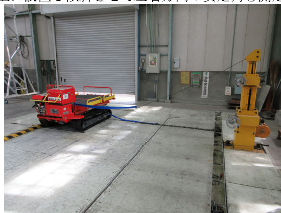
左写真：左右分担荷重測定、右写真：傾斜台への設置状況（チェーン・スリング等で転倒防止）
