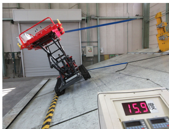
左写真：右方向不利時の左右分担荷重測定、右写真：右方向安定角測定
