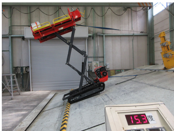
左写真：前方向安定角測定、右写真：後方向安定角測定
