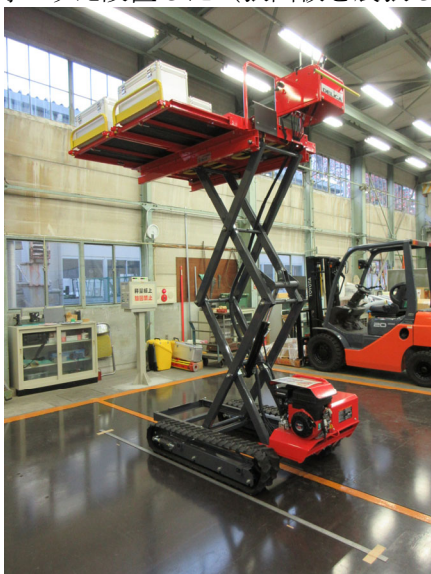
左写真：左方向不利時の左右分担荷重測定、右写真：左方向安定角測定
