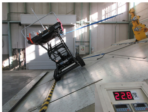
左写真：右方向不利時の左右分担荷重測定、右写真：右方向安定角測定
