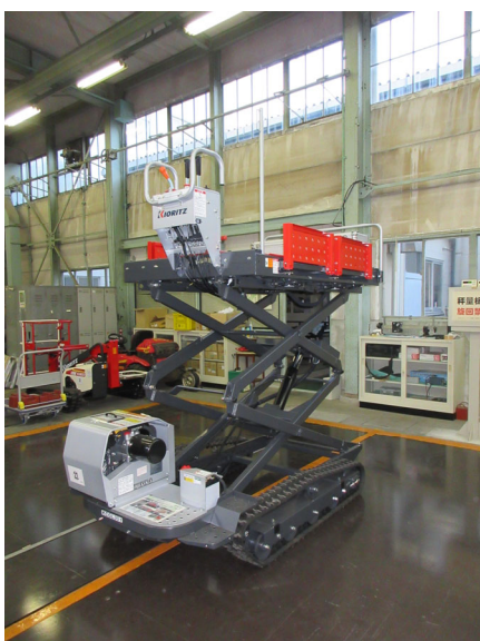
左写真：前方向不利時の左右分担荷重測定、右写真：前方向安定角測定
