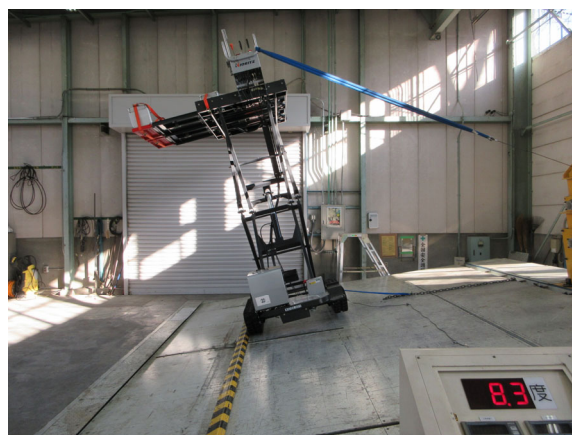
左写真：左方向不利時の左右分担荷重測定、右写真：左方向安定角測定
