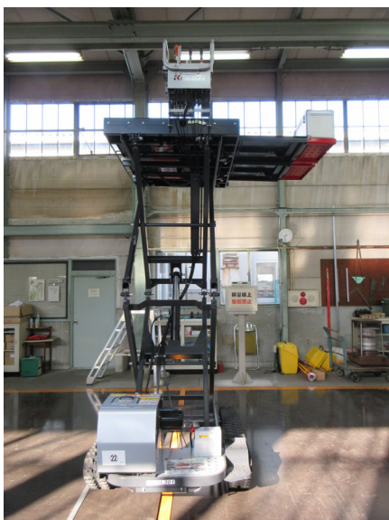
左写真：右方向不利時の左右分担荷重測定、右写真：右方向安定角測定
