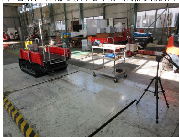
左写真：反射テープを 4 辺に貼付した枠、右写真：試験の様子（三脚上に反射型光電管）
