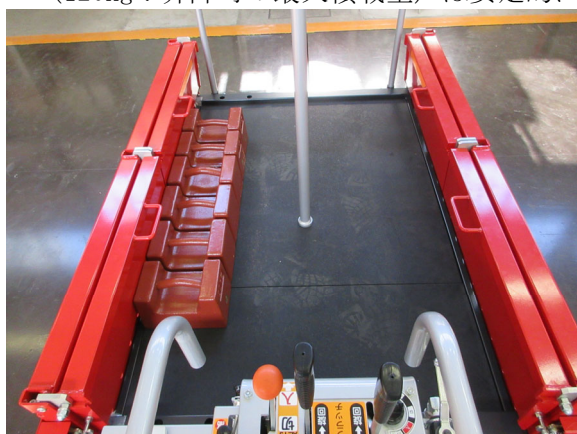
左写真：左方向不利時の左右分担荷重測定、右写真：左方向安定角測定
