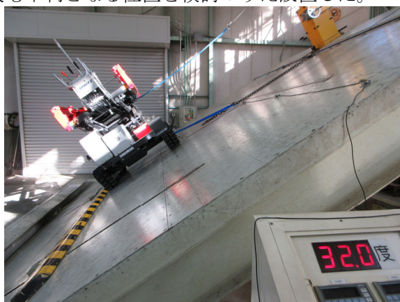
左写真：左方向不利時の左右分担荷重測定、右写真：左方向安定角測定
