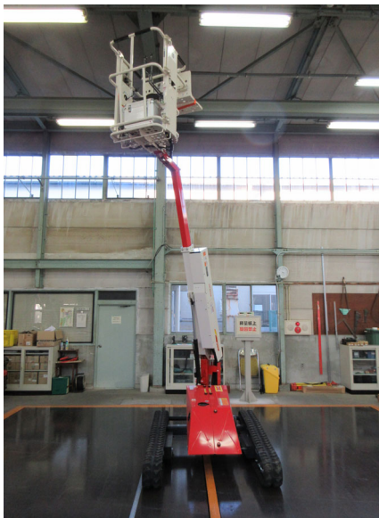
【ブーム角度最大】左写真：左方向不利時の左右分担荷重測定、右写真：左方向安定角測定
