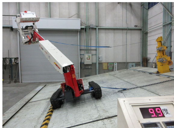
【ブーム角度半分程度】左写真：右方向不利時の左右分担荷重測定、右写真：右方向安定角測定 ※前方向についてはブーム角度最大時が最も不利なためブーム角度半分程度の測定は実施しない
