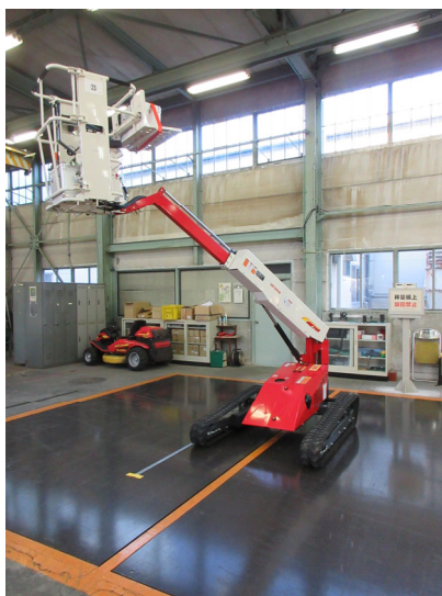
【ブーム角度半分程度】左写真：左方向不利時の左右分担荷重測定、右写真：左方向安定角測定
