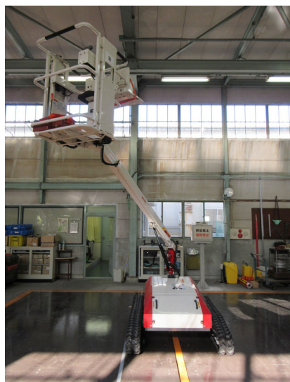
【ブーム角度半分程度】左写真：左方向不利時の左右分担荷重測定、右写真：左方向安定角測定
