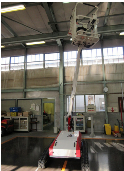
【ブーム角度最大】左写真：前方向不利時の左右分担荷重測定、右写真：前方向安定角測定
