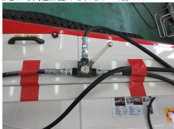
左写真：昇降用油圧シリンダ作動油出口付近の配管変更、右写真：三方ボールバルブ
