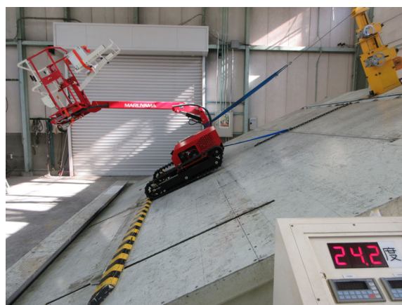
【ブーム角度半分程度】左写真：後方向不利時の左右分担荷重測定、右写真：後方向安定角測定
