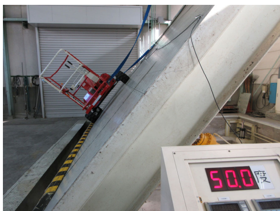
左写真：左方向安定角測定、右写真：右方向安定角測定（安全のため 50^\circ で試験終了）
