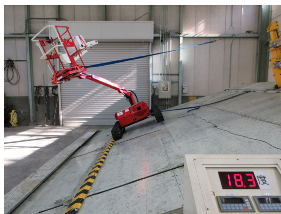
【ブーム角度半分程度】左写真：左方向不利時の左右分担荷重測定、右写真：左方向安定角測定
