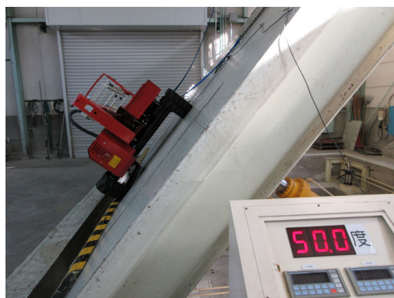
左写真：左方向安定角測定、右写真：右方向安定角測定（安全のため 50^\circ で試験終了）
