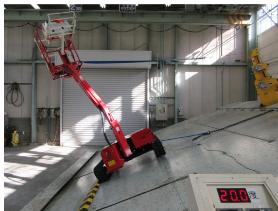
【ブーム角度最大】左写真：右方向不利時の左右分担荷重測定、右写真：右方向安定角測定
