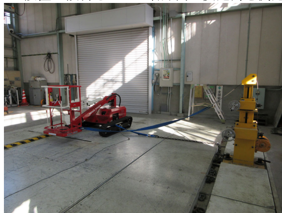
左写真：左右分担荷重測定、右写真：傾斜台への設置状況（チェーン・スリング等で転倒防止）
