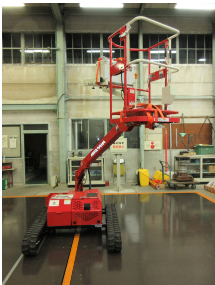
【ブーム角度半分程度】左写真：右方向不利時の左右分担荷重測定、右写真：右方向安定角測定 ※前方向についてはブーム角度最大時が最も不利なためブーム角度半分程度の測定は実施しない
