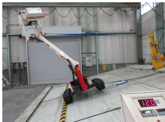
【ブーム角度最大】左写真：右方向不利時の左右分担荷重測定、右写真：右方向安定角測定
