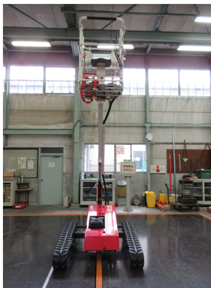
【ブーム角度最大】左写真：後方向不利時の左右分担荷重測定、右写真：後方向安定角測定
