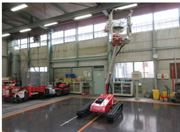
【ブーム角度最大】左写真：右方向不利時の左右分担荷重測定、右写真：右方向安定角測定
