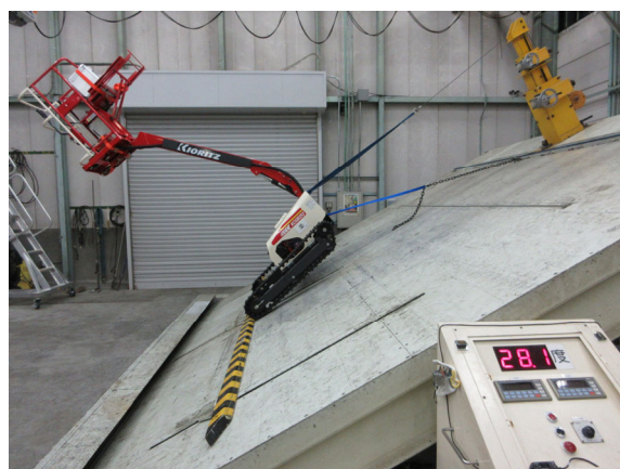
【ブーム角度最大】左写真：後方向不利時の左右分担荷重測定、右写真：後方向安定角測定
