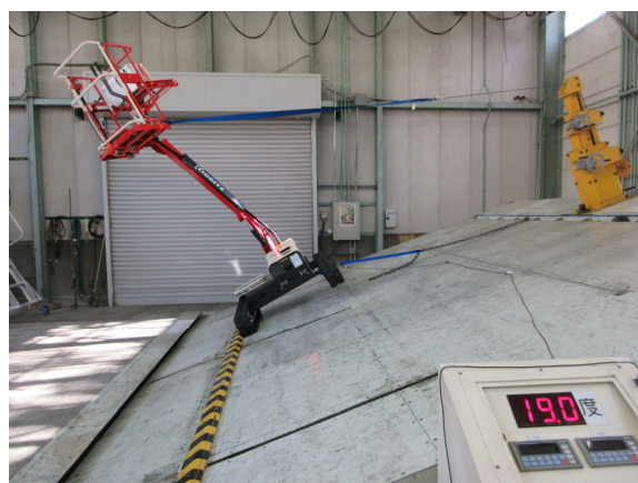
【ブーム角度最大】左写真：左方向不利時の左右分担荷重測定、右写真：左方向安定角測定
