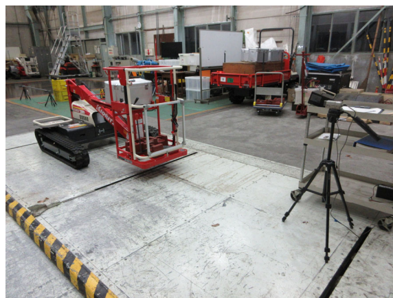
左写真：反射テープを4辺に貼付した枠、右写真：試験の様子（三脚上に反射型光電管）
