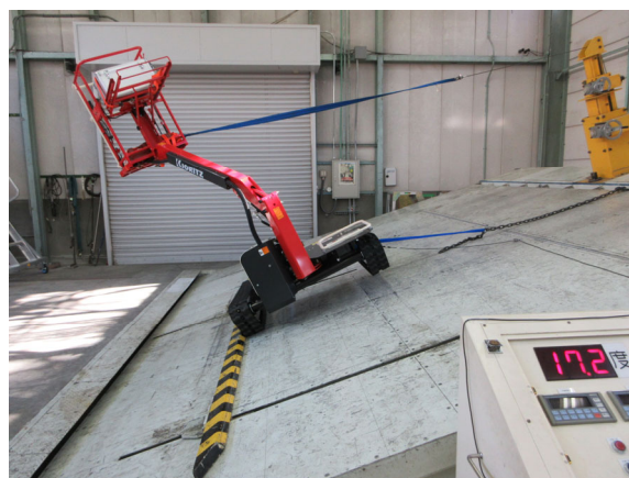
【ブーム角度半分程度】左写真：右方向不利時の左右分担荷重測定、右写真：右方向安定角測定
