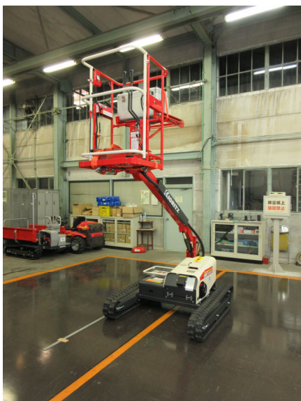
【ブーム角度半分程度】左写真：後方向不利時の左右分担荷重測定、右写真：後方向安定角測定
