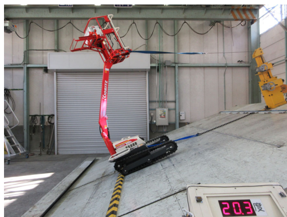
【ブーム角度最大】左写真：前方向不利時の左右分担荷重測定、右写真：前方向安定角測定
