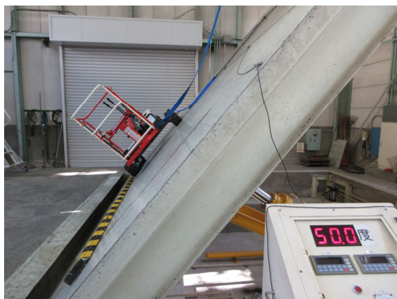
左写真：左方向安定角測定、右写真：右方向安定角測定（安全のため 50° で試験終了）
