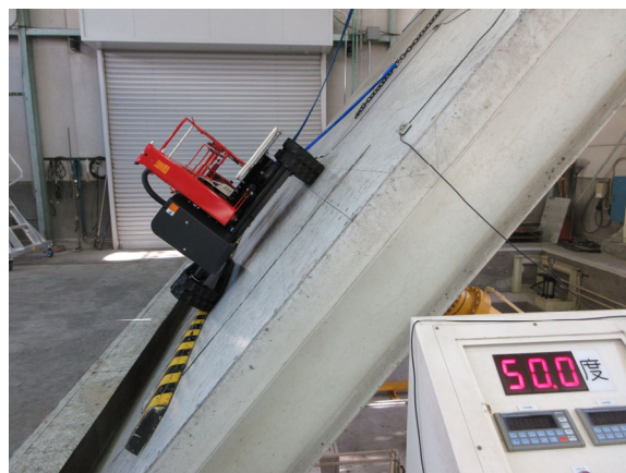
左写真：左方向安定角測定、右写真：右方向安定角測定（安全のため 50° で試験終了）
