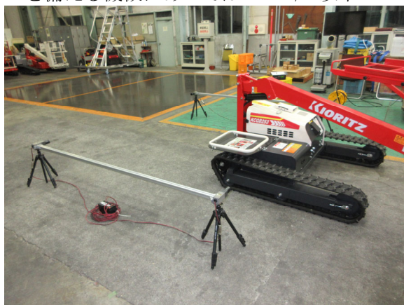
歩行運転時最高走行速度測定試験の様子
