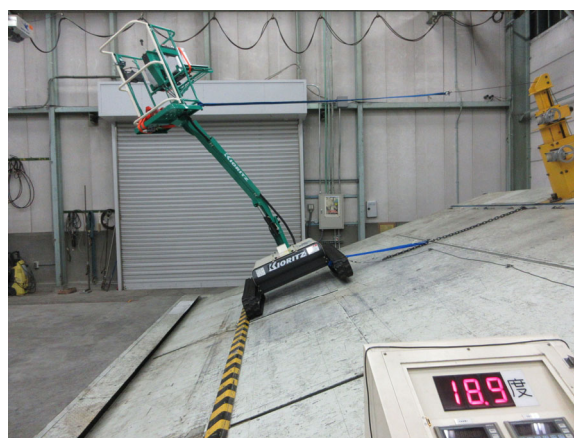
【ブーム角度最大】左写真：左方向不利時の左右分担荷重測定、右写真：左方向安定角測定
