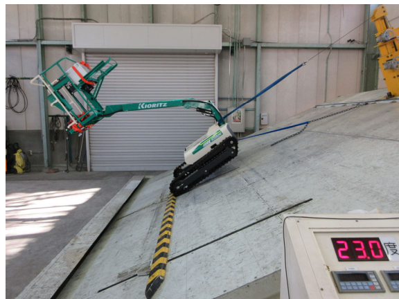
【ブーム角度半分程度】左写真：後方向不利時の左右分担荷重測定、右写真：後方向安定角測定
