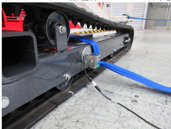
左写真：レーザセンサ取付状況、右写真：チョークの目印（ともに別型式の写真）
