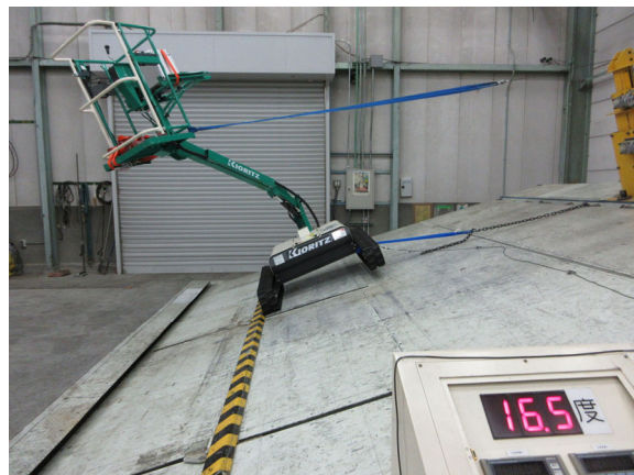
【ブーム角度半分程度】左写真：左方向不利時の左右分担荷重測定、右写真：左方向安定角測定
