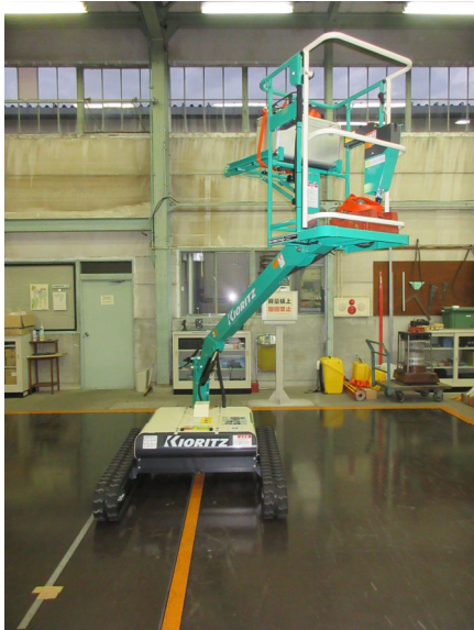
【ブーム角度半分程度】左写真：右方向不利時の左右分担荷重測定、右写真：右方向安定角測定
