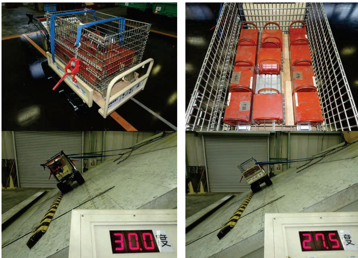
④ばら積みの最大積載状態（等荷重）での左右方向の静的転倒角（左下：左側転倒、右下：右側転倒）
