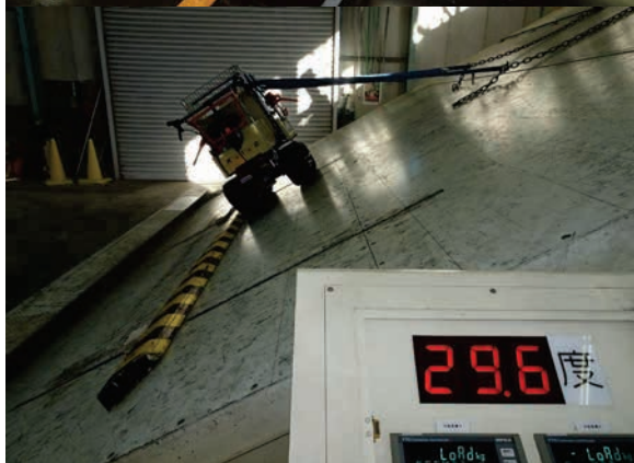
②コンテナ積載状態（等荷重）の左右方向の静的転倒角（左下：左側転倒、右下：右側転倒）
