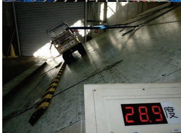
②コンテナ積載状態（等荷重）の左右方向の静的転倒角（左下：左側転倒、右下：右側転倒）
