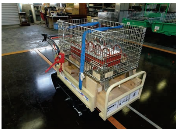
②コンテナ積載状態（等荷重）の左右方向の静的転倒角（左下：左側転倒、右下：右側転倒）
