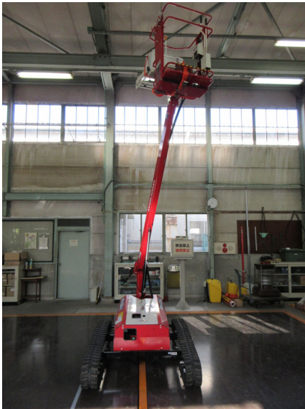
【ブーム角度最大】左写真：右方向不利時の左右分担荷重測定、右写真：右方向安定角測定
