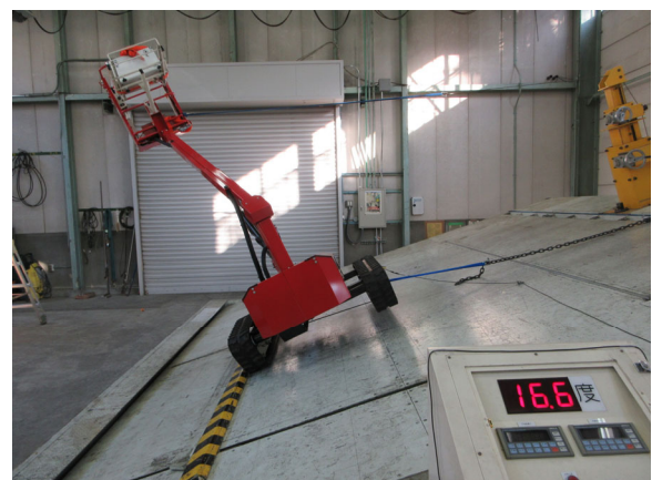
【ブーム角度半分程度】左写真：右方向不利時の左右分担荷重測定、右写真：右方向安定角測定
