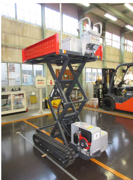
左写真：後方向不利時の左右分担荷重測定、右写真：後方向安定角測定
