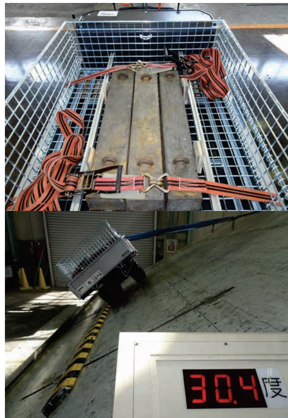
②コンテナ積載状態（等荷重）の左右方向の静的転倒角（左下：左側転倒、右下：右側転倒）
