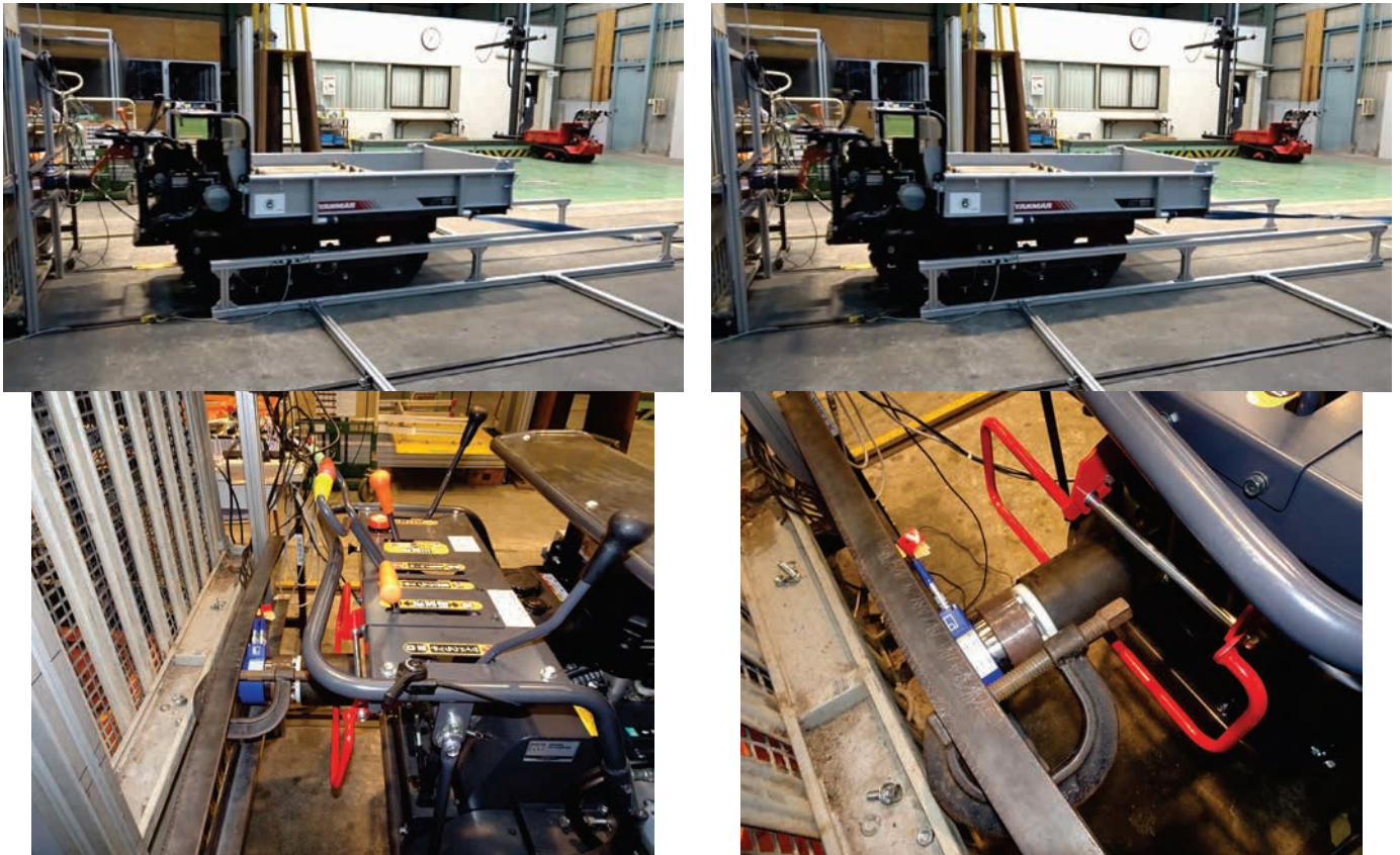
※左上：接触の瞬間、右上：機体後方がやや持ち上がった様子、下：機体停止後の状況（全て1速時）
