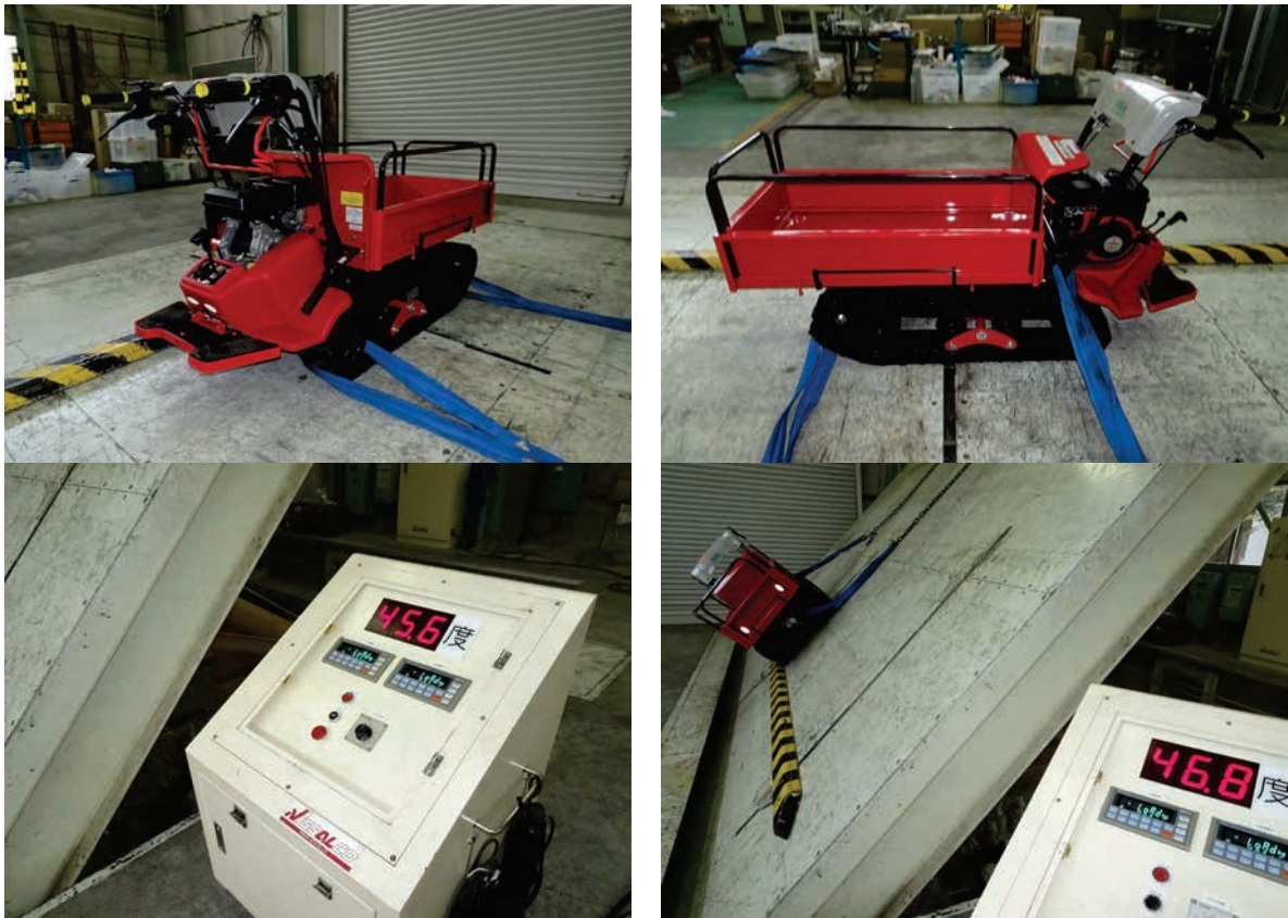
①空車時の左右方向の静的転倒角（左下：左側転倒、右下：右側転倒）
