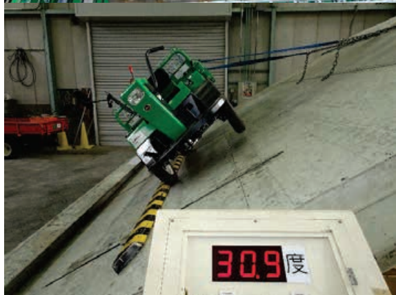
②コンテナ積載状態(等荷重)の左右方向の静的転倒角（左下：左側2次転倒、右下：右側2次転倒）
