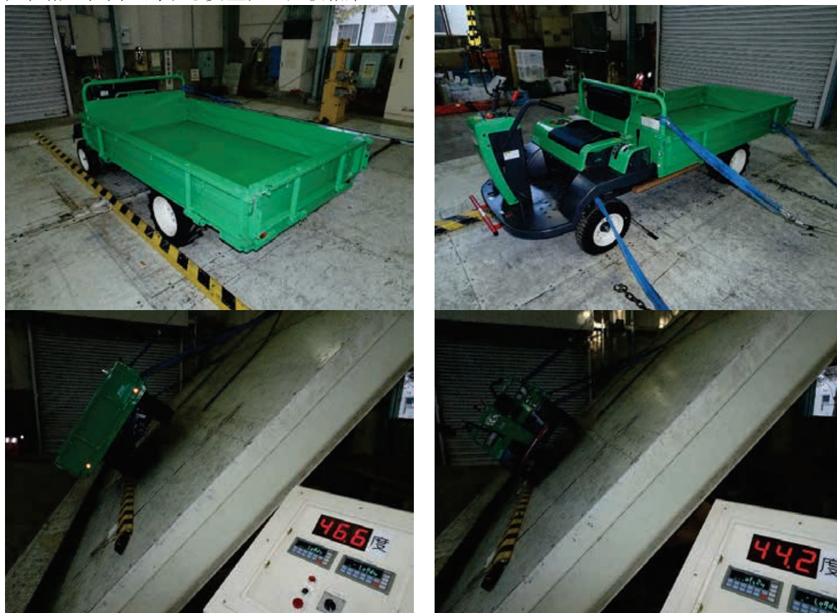
①空車時の左右方向の静的転倒角（左下：左側 2 次転倒、右下：右側 2 次転倒）
