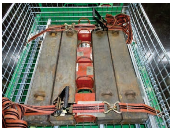
②コンテナ積載状態(等荷重)の左右方向の静的転倒角（左下：左側2次転倒、右下：右側2次転倒）
