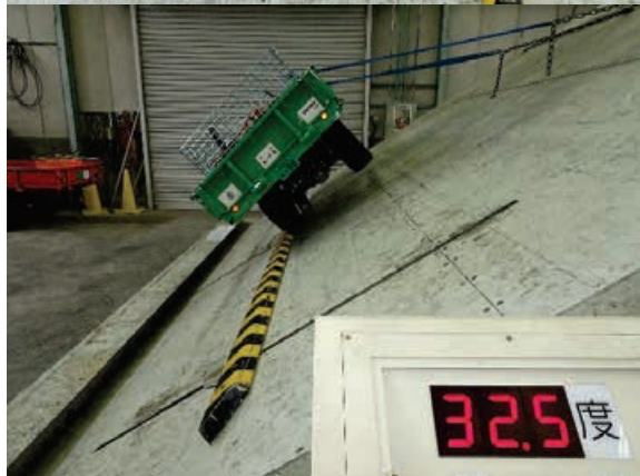
②コンテナ積載状態(等荷重)の左右方向の静的転倒角（左下：左側2次転倒、右下：右側2次転倒）
