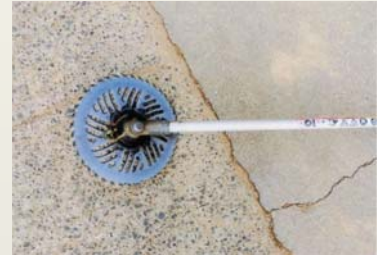
刈払機安全カバー欠落
