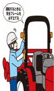
・安全キャブ、フレームのあるトラクターを使用する
