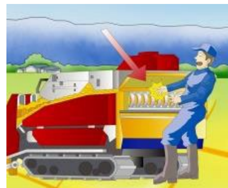
カッター部への巻き込まれ
