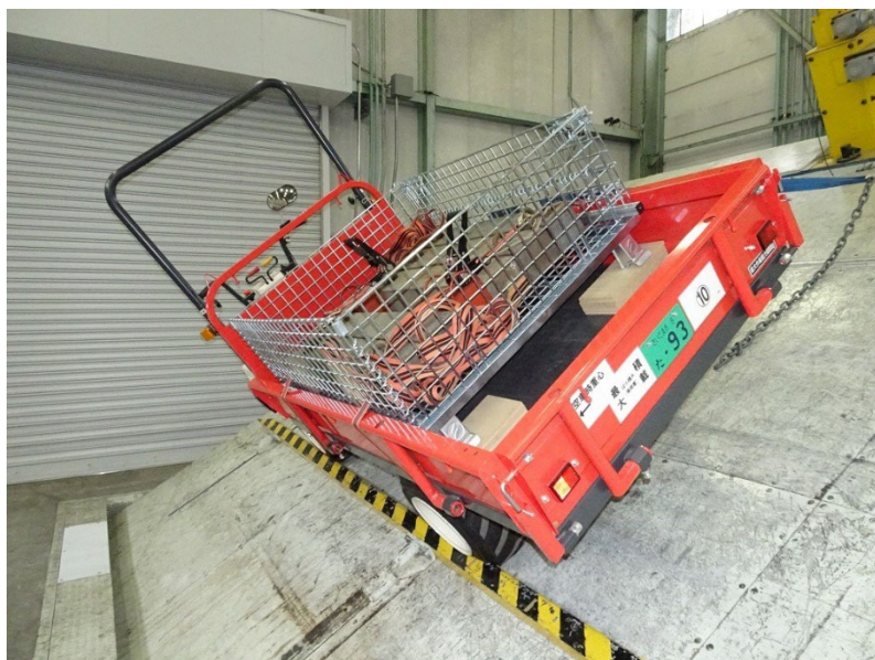
静的転倒角測定試験（11/21～22）の様子
