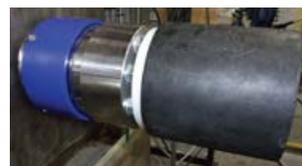
6分力計により挟まれ中の荷重・モーメント測定
