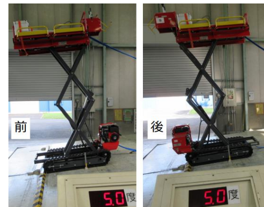
垂直昇降型農用高所作業機の安定角試験イメージ
