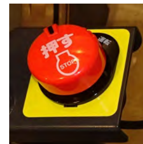
緊急停止 ボタン
