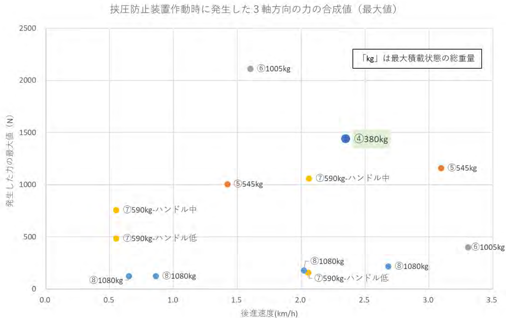
図3-3 挟圧防止装置作動時に発生した3軸方向の力の合成値（最大値）の比較（実際の事故の状況とは異なる可能性がある）
