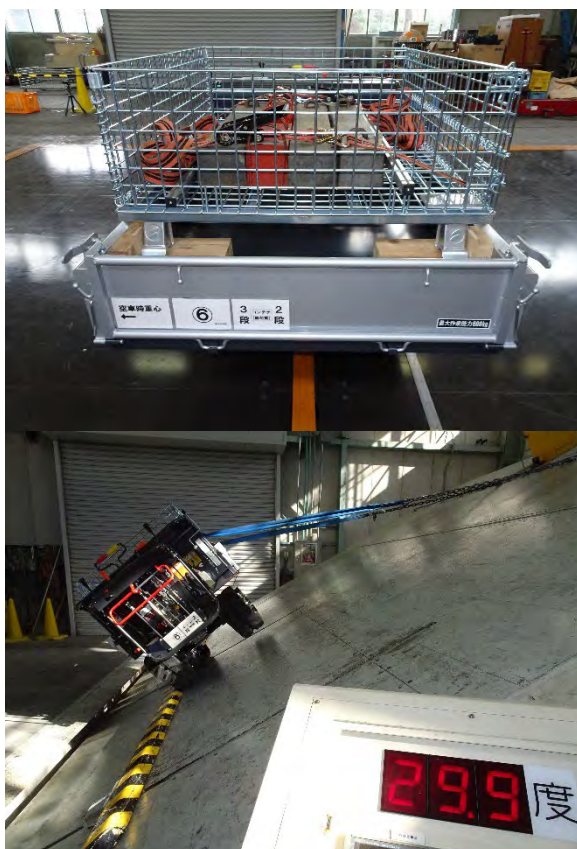
③コンテナ積載状態（偏荷重）の左右方向の静的転倒角（左下：左側転倒、右下：右側転倒）
