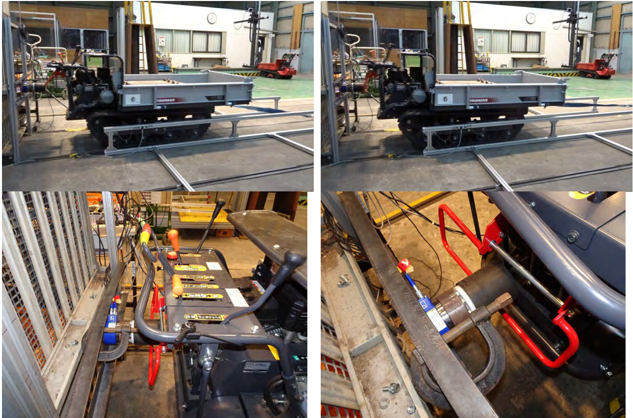
※左上：接触の瞬間、右上：機体後方がやや持ち上がった様子、下：機体停止後の状況（全て1速時）
