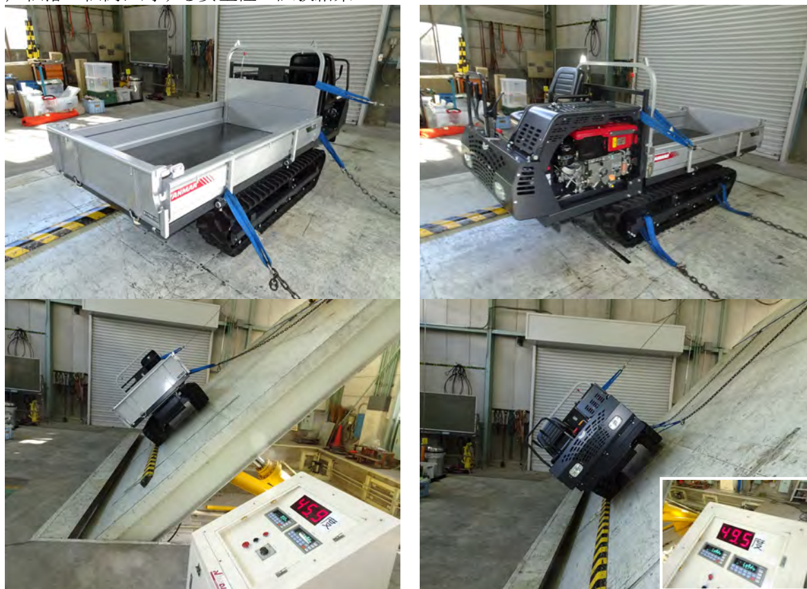
①空車時の左右方向の静的転倒角（左下：左側転倒、右下：右側転倒）
