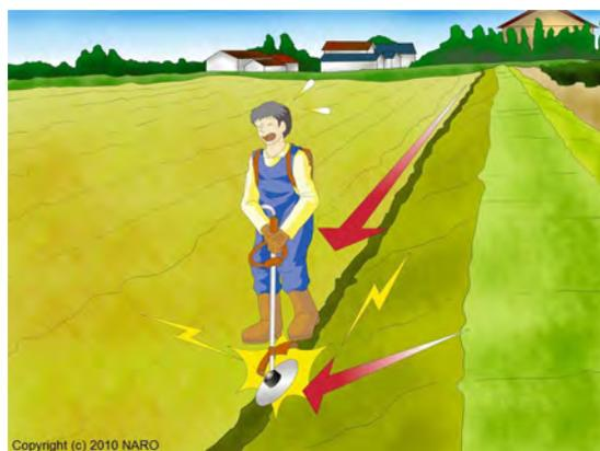
ので、刈刃が地面に接地した時、刈刃は手前の自分方向に向かってキックバックして、足などを負傷する。地面に刃が接地することはよくあることである。
