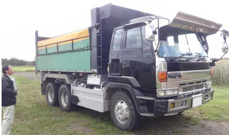
フックを溶接し、サイドのアオリの歪みを直そうとしたダンプ
