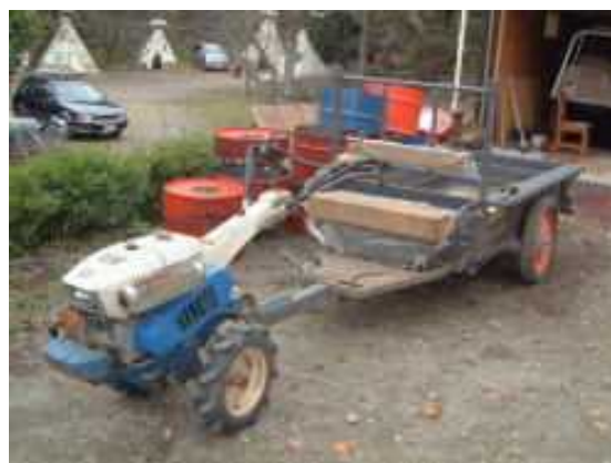
(耕耘機が牽引するトレーラー)
