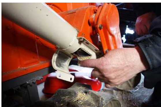
ラセンを回しながら、残った糶を軍手をした指で掻き出していて、軍手と共に指が巻き込まれた。
