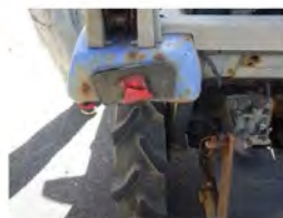
リフレクター破損
