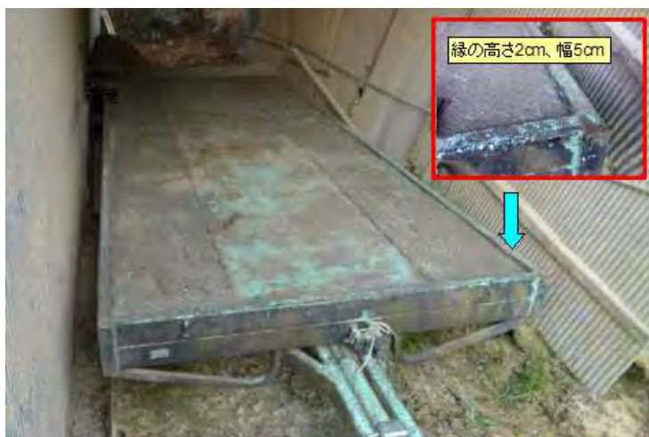
コンバイン台車(長さ450cm×幅180cm×高さ60cm)に、管理機を乗せようとして左側(写真では右側)の縁に前輪が乗り上げ、修正しようとしたが、雨で滑って転落
