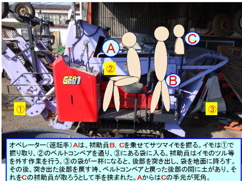
オペレーター(運転手)Aは、補助員B、Cを乗せてサツマイモを掘る。イモは①で掘り取り、②のベルトコンベアを通り、③にある袋に入る。補助員はイモのツル等を外す作業を行う。③の袋が一杯になると、後部を突き出し、袋を地面に降ろす。その後、突き出した後部を戻す時、ベルトコンベアと戻った後部の間に土があり、それをCの補助員が取ろうとして手を挟まれた。AからはCの手元が死角。
