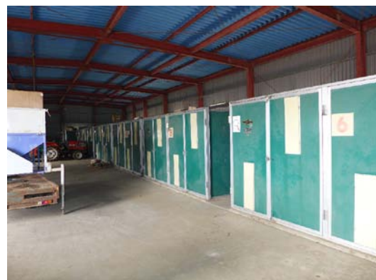
たばこの葉の乾燥施設。昔は土蔵づくりの乾燥施設で、薪を昼夜わかつた燃やし続け、温度調整を行っていた。
