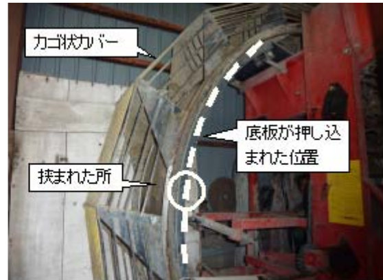
図3 ロータリコンベアに扶まれた箇所
