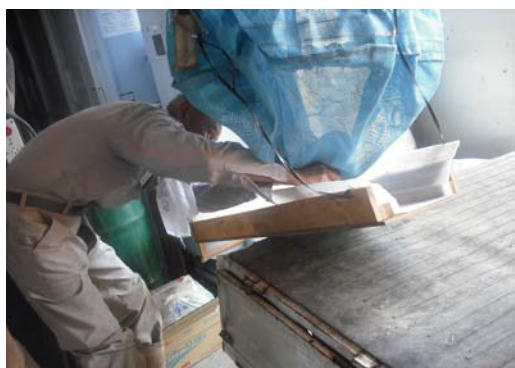
フレコンの粉出しのため、開口紐を引こうと、フレコンの下に入った
