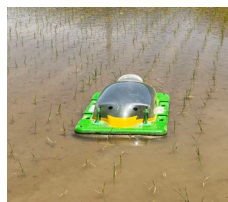
▲畝間を自動走行できる電動除草ロボット
