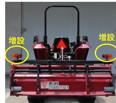
<直装式作業機で本体の灯火器類が見えない場合の例>
