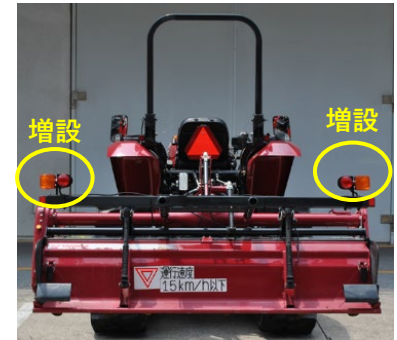
<直装式作業機で本体の灯火器類が見えない場合の例>
