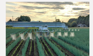
自立走行型ロボットによるねぎの農薬散布
