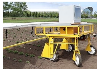
自動検出プログラム搭載の管理車両(6畦同時検出)
