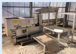
▲共同利用している機械 左：石抜き機、右：回転調製機
