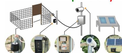
電子トリガー 侵入センサー 主装置 ネットワークカメラ ソーラー・バッテリーシステム
