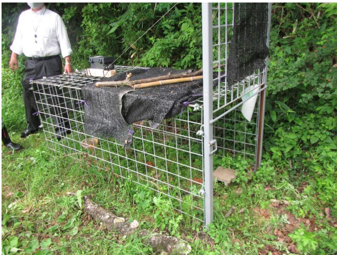
自動捕獲システム搭載箱わな
