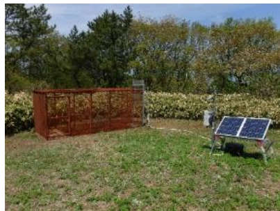
【ICT活用遠隔操作檻設置状況】
