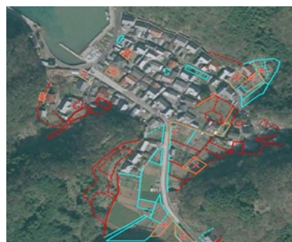
防護柵設置状況をGISで可視化
