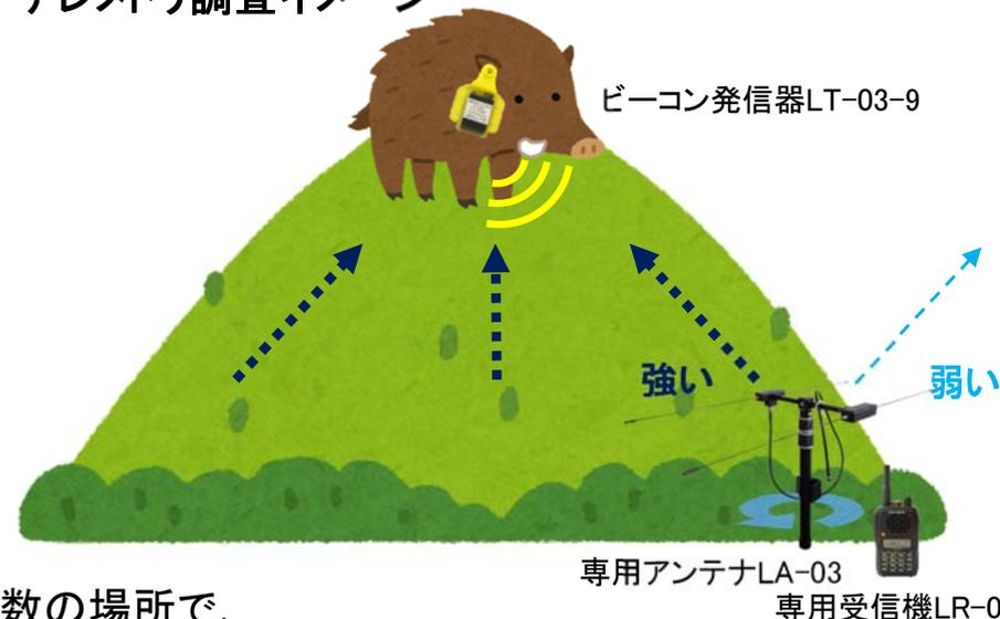
複数の場所で、アンテナの向きを変えて電波の強弱を調べることで、電波の発信方向を特定し、イノシシの現在地を調査する。
