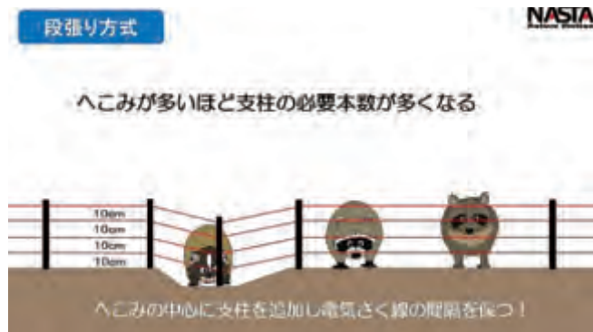
図8 支柱を増やして地表面と電気さく線の間隔が広がらないようにする。へこみが多いと支柱の本数が多くなるので事前に地ならししておくとい。
