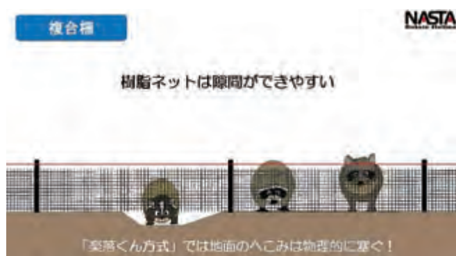
図13 楽落くん方式を設置する場合は地表面を整地することが基本だが、樹脂ネットでは隙間がしやすい。
