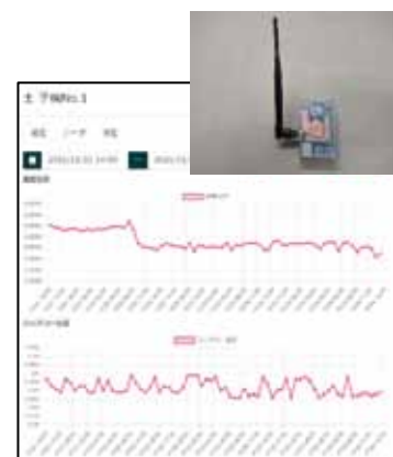
通信機能を有するスマート 電気柵
